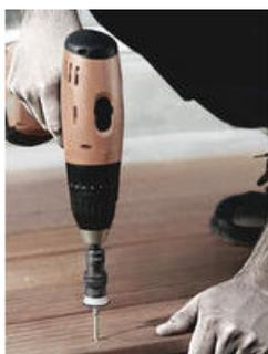
Porte-embouts pour noyer uniformément les vis dans les planches en bois pour la construction de terrasses
