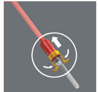
Continuer à tirer l'agrippe-vis en direction du manche du tournevis jusqu'à ce que les deux serres buttent contre la tête de la vis et s'écartent légèrement. L'agrippe-vis Wera relâche la vis automatiquement à l'issue du vissage !
