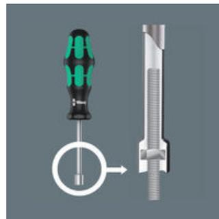
Les tournevis à lame creuse sont utiles pour les vissages sur tiges fileté. En effet, la tige fileté pénètre dans la tige creuse du tournevis, ce qui permet d'actionner l'écrou.
