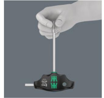
Le serrage de la vis à six pans creux sur la pointe de l'outil est assuré par une bille élastique. C'est particulièrement utile dans les endroits exigus où il n'est pas possible de tenir la vis avec l'autre main.
