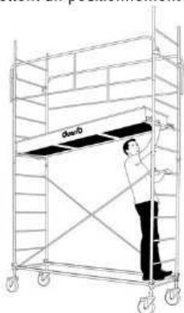
**14** Positionnez le plancher horizontalement à la hauteur de travail et mettez les verrous du plancher pour l'anti-soulèvement.
