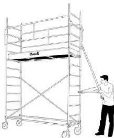
**18** Déployez la coulisse du stabilisateur jusqu'au sol à l'aide de la commande manuelle.
