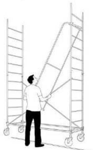
**9** Accrochez la diagonale au garde-corps en passant le crochet dans le trou. Utilisez la diagonale comme perche de commande pour installer le garde-corps en contournant le montant par l'extérieur.
