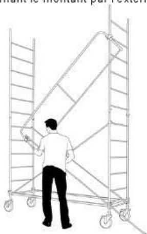
**10** Rapprochez la diagonale du montant et le garde-corps se positionnera sur le barreau d'échelle. Récupérez la diagonale.
