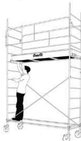
**15** Approchez le stabilisateur au montant d'échelle verticalement. Accrochez la partie haute au barreau préconisé par cette notice page 3, 5 ou 7.
