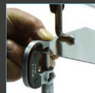
2 points de mesure à l'aide d'un micromètre
